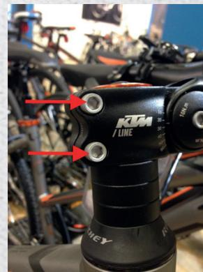
**Wichtig:** Bei der Montage des Ahead-Lenkervorbaus, darf die oben liegende Steuersatz-Schraube nicht verstellt werden.
